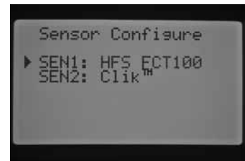
SEN1 - átfolyás érzékelő (HFS FCT100) SEN2 - mikrokapcsolós érzékelő
