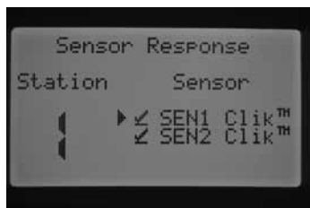
az 1-es zóna mindkét érzékelő jelére reagál
