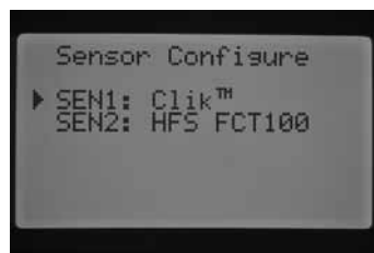
SEN1 - mikrokapcsolós érzékelő SEN2 - átfolyás érzékelő (HFS FCT100)
