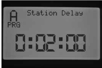
pl.: az A programban a zónák indítása közötti szünet 2 perc
