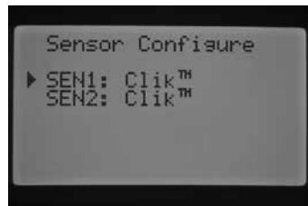
SEN1 és SEN2 - alapállapotban zárt mikrokapcsolós érzékelő
